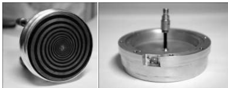
Рис. 3. – Изготовленная спиральная антенна
