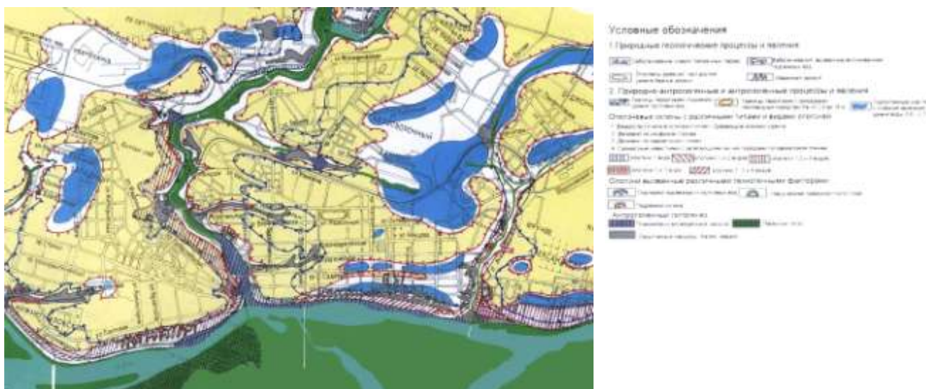
Рис. 2 - Склоны балок подверженные оползневым процессам.
