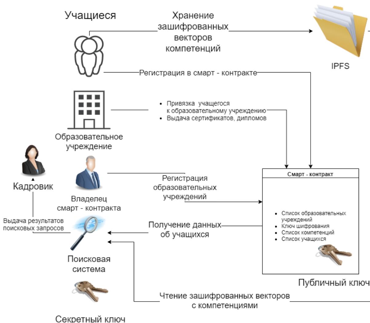
Рис. 2. – Схема взаимодействия компонентов поисковой системы подбора персонала и её архитектура
