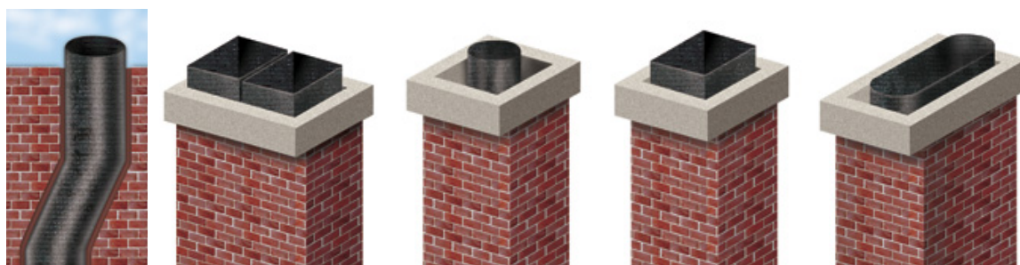
Рис.6 Варианты монтажа бытовых каналов.
