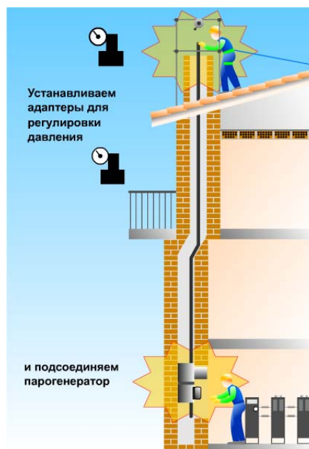
Рис. 4 Подготовительные технологические мероприятия к процессу полимеризации.
