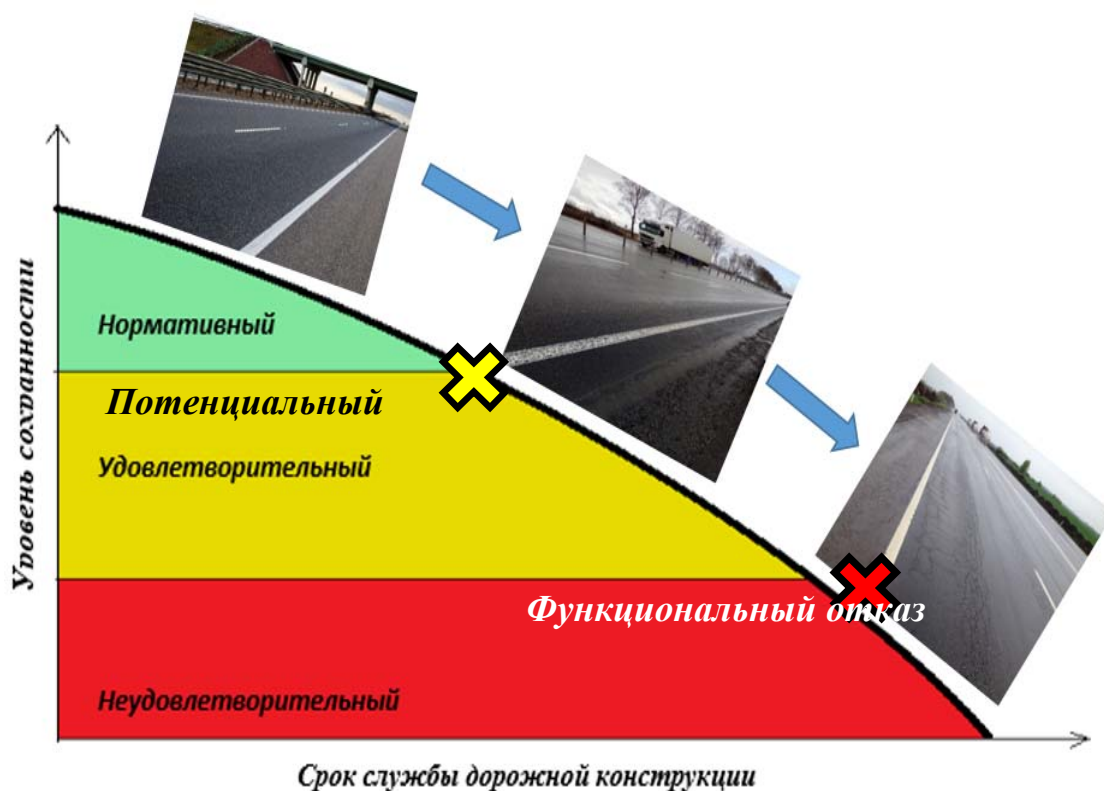
Рис. 1. - Кривая ухудшения состояния дорожной одежды в течение ее срока службы
