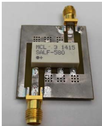
Рис. 6. – Фото макета фильтра нижних частот SALF-580
