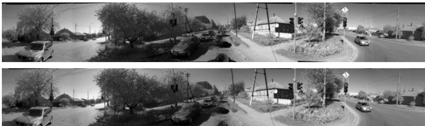
Рис. 3. – Панорамное изображение при разных дальностях «сшивки»: 20 м (сверху), бесконечная дальность (снизу).
