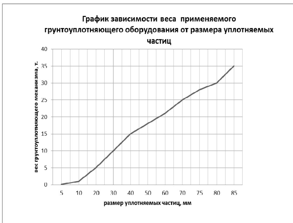
Рис. 1. – Зависимость веса применяемого грунтоуплотняющего оборудования от размера уплотняемых частиц
