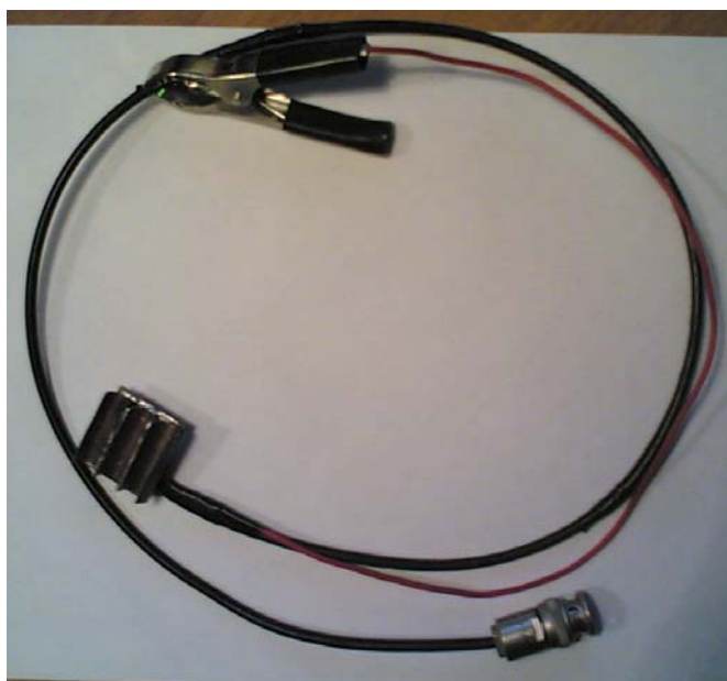
Рис. 1. – Макетный образец емкостного делителя напряжения для 3-х цилиндрического ДВС
