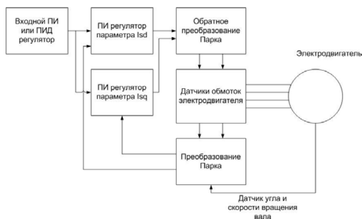
Рис. 1. – Структура векторного регулятора для шагового электродвигателя
