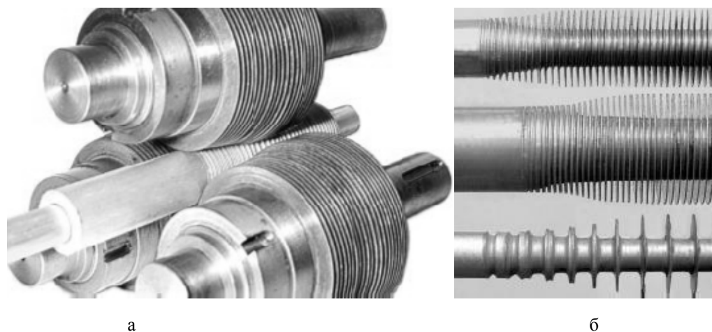
Рис. 5. – Процесс поперечной прокатки: (а) – трехосные угловые валки, (б) – ребра [9]
