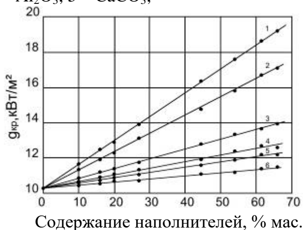
Рис.10 - Зависимость критической плотности теплового потока воспламенения эпоксидных полимеррастворов от содержания минеральных наполнителей: 1- \text{Al}(\text{OH})_3 ; 2- \text{Mg}(\text{OH})_2 ; 3- \text{CaCO}_3 ; 4-гетит; 5- \text{MgO} ; 6-андезит.
