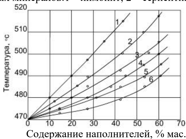
Рис.9 - Зависимость температуры самовоспламенения эпоксидных полимеррастворов от содержания минеральных наполнителей: 1 – \text{Al}(\text{OH})_3 ; 2 – \text{Mg}(\text{OH})_2 ; 3 – \text{MgO} ; 4 – \text{Al}_2\text{O}_3 ; 5 – \text{CaCO}_3 ;
