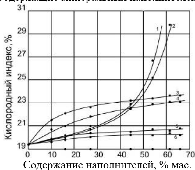
Рис.7 - Зависимость кислородного индекса эпоксидных полимеррастворов от химической природы и содержания минеральных наполнителей: 1 - Mg (OH) 2 ; 2 - Al(OH) 3 ; 3 - андезит; 4 - гетит; 5 - CaCO 3 ; 6 - Al 2 O 3 .
