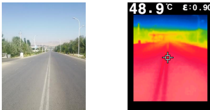
Рис. 2 - Тепловизионная съемка автодорог. Июнь. 14:00 ч.
