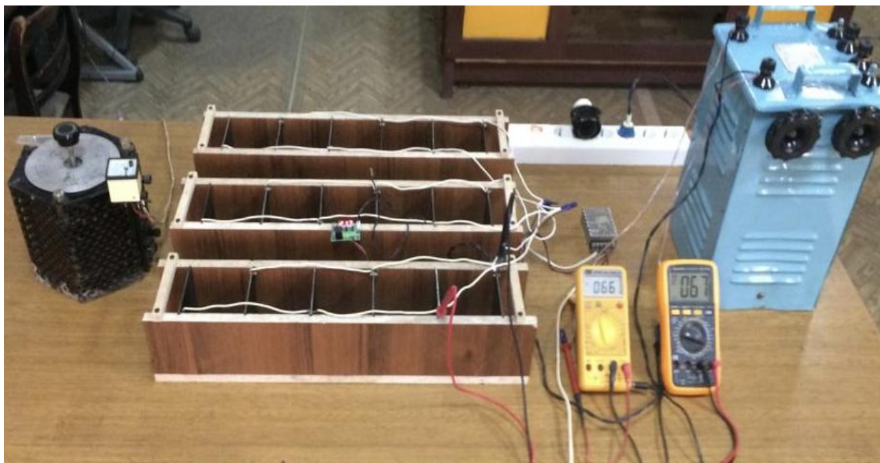
Рис. 1. – Лабораторный стенд для предварительного форсированного электроразогрева керамзитобетонной смеси
