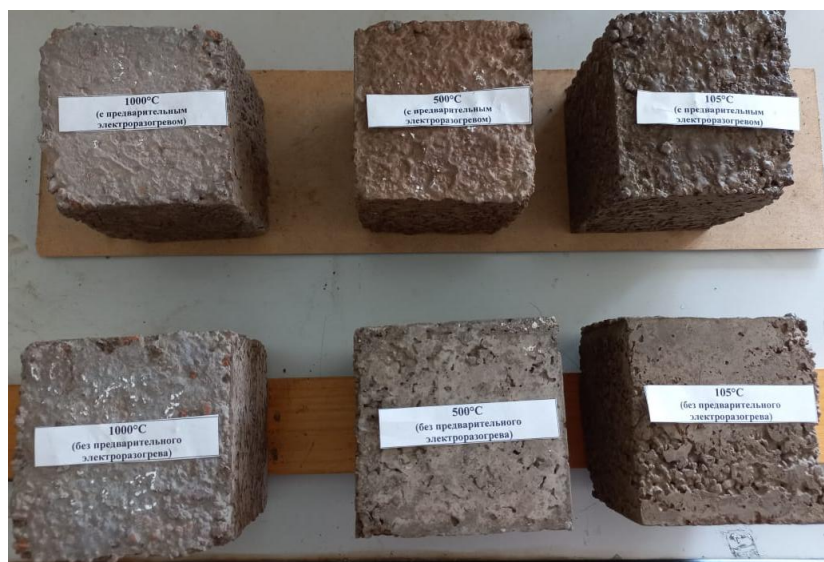
Рис. 4. – Образцы жаростойкого керамзитобетона после сушки 105° С и после нагрева до 500 и 1000° (нижний ряд – с предварительным форсированным электроразогревом керамзитобетонной смеси)
