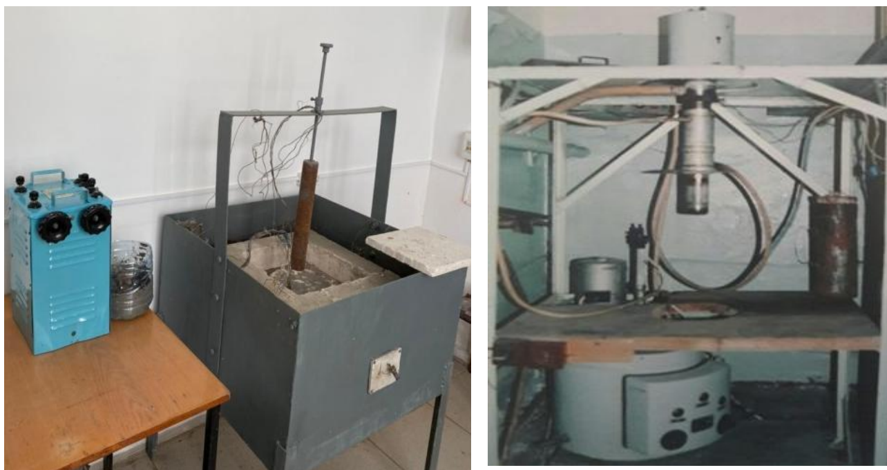
Рис. 2. – Общий вид установки для определения теплопроводности бетона (слева) и установки для определения коэффициента линейного температурного расширения жаростойкого керамзитобетона
