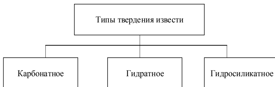
Рисунок 4. – Типы твердения извести
