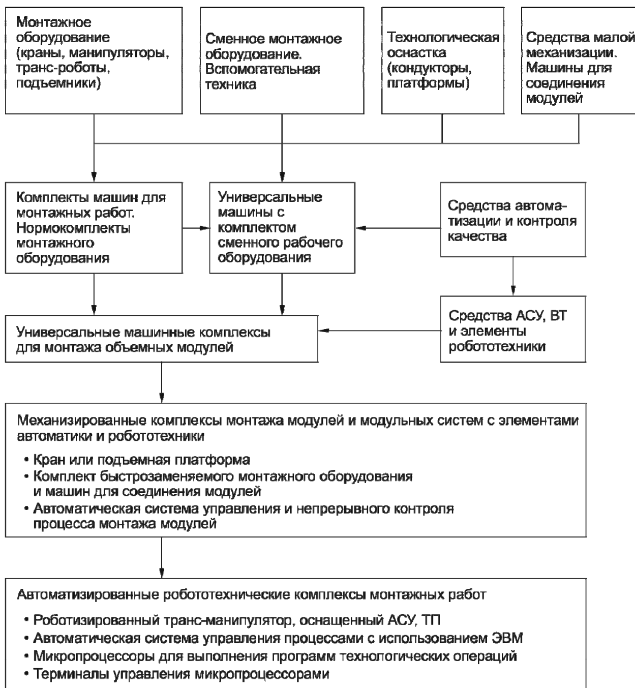
Рис. 3. – Развитие средств комплексной механизации модульного строительства
