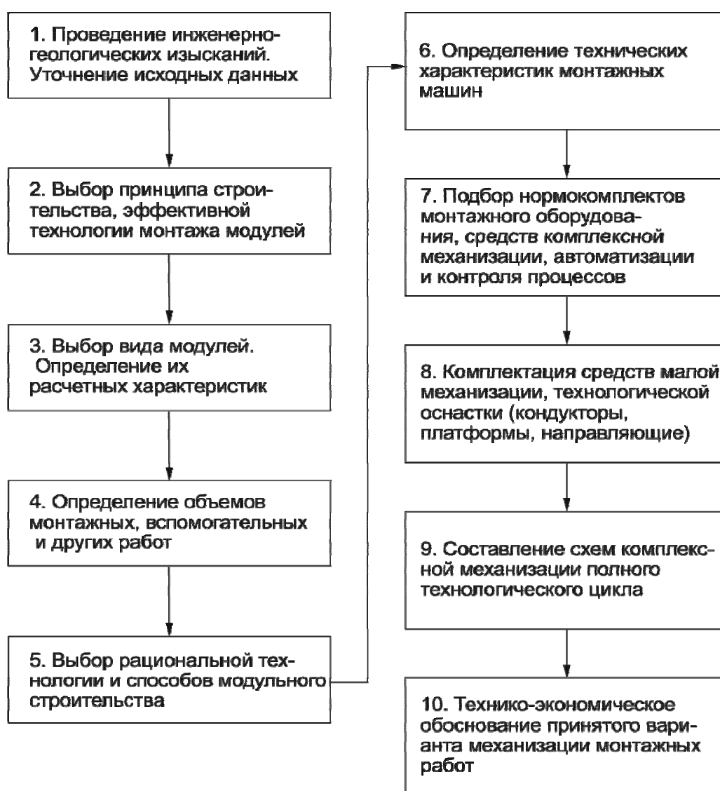
Рис. 1. –Последовательность проектирования схем механизации при модульном строительстве
