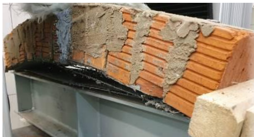
Рис. 1. – Испытание образцов сводчатых арок
