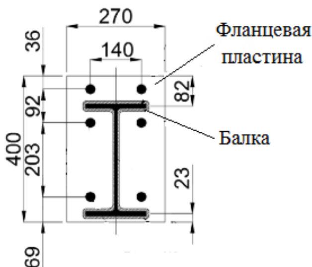
Рис. 7. – Параметры фланцевой пластины соединения при проведении испытаний [15]
