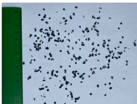
Рис. 3. – Образец микрофотографий для автоматизированного размерного анализа пыли
