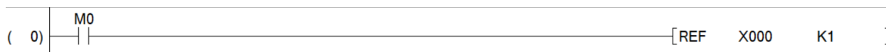
Рис. 3. – Применение команды REF (язык LD) для обновления информации о состоянии входа X000
