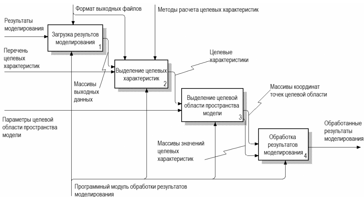
Рис. 1. – Функциональная модель методики автоматизации обработки результатов численного моделирования развития пожара
